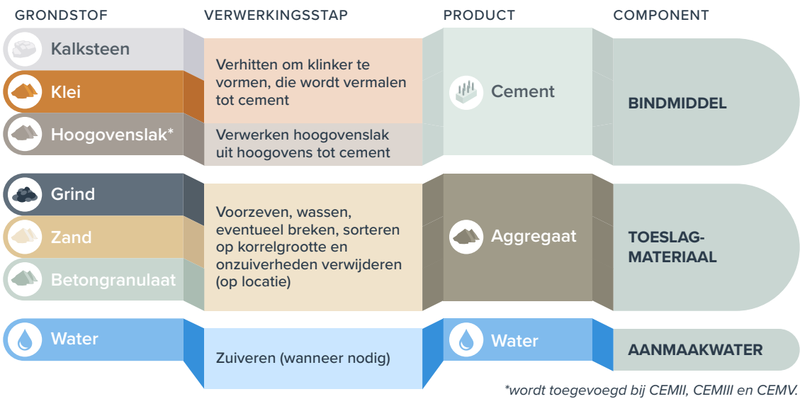
Figuur 6: Productieketen van beton
